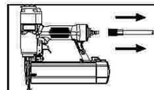
Desconecte la manguera de la máquina.
