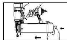
Empuje la tapa del cargador hasta que alcance la lengüeta y quede fijado.
