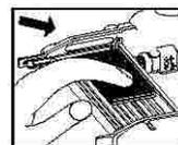
Inserte el consumible en el cargador y compruebe que la fijación apunta hacia abajo y que el peine no está sucio o dañado.
